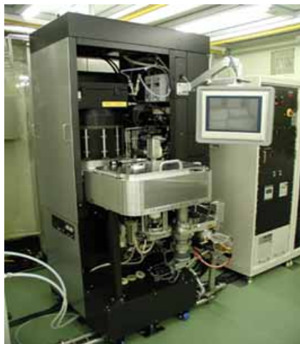
プラズマドーピング装置
